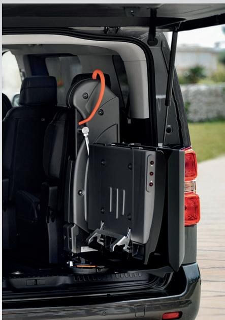
Grazie alla capacità progettuale Focaccia Group è in grado di realizzare componenti in ABS termoformato in linea con gli standard estetici e qualitativi delle case automobilistiche. Ne è un esempio il kit di installazione del pannello di comando e della pompa di movimentazione manuale del Sollevatore Fiorella nelle pannellature del veicolo.
