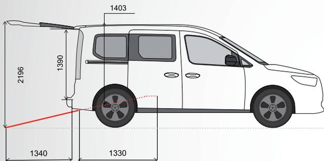
Altezza punto di ingresso 1390 mm | Altezza interna utile 1403 mm | Lunghezza utile tra gli ancoraggi 1035 mm | Lunghezza piano carrozzina 1330 mm | Larghezza utile piano carrozzina 785 mm | Lunghezza rampa aperta 1340 mm | Ampiezza utile rampa 763 mm | Altezza del portellone aperto 2196 mm
