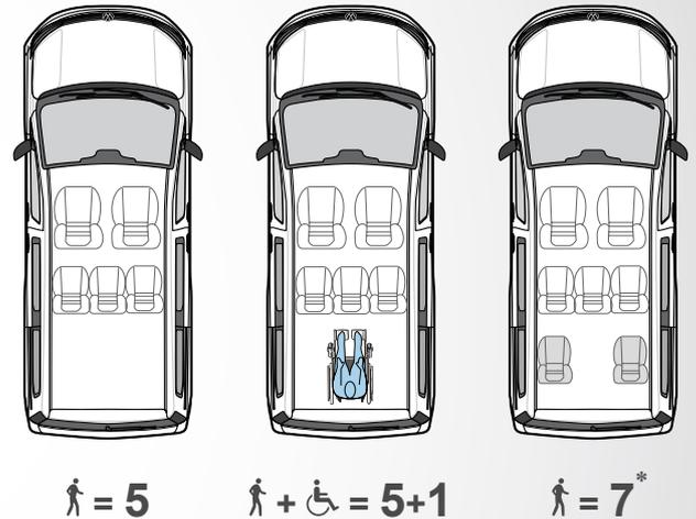
Altezza punto di ingresso 1395 mm | Altezza interna utile 1430 mm | Lunghezza tra gli ancoraggi 1120 mm | Lunghezza area stazionamento carrozzina 1300 mm | Larghezza area stazionamento carrozzina 815 mm | Lunghezza rampa aperta 1390 mm | Larghezza utile rampa di accesso 765 mm
