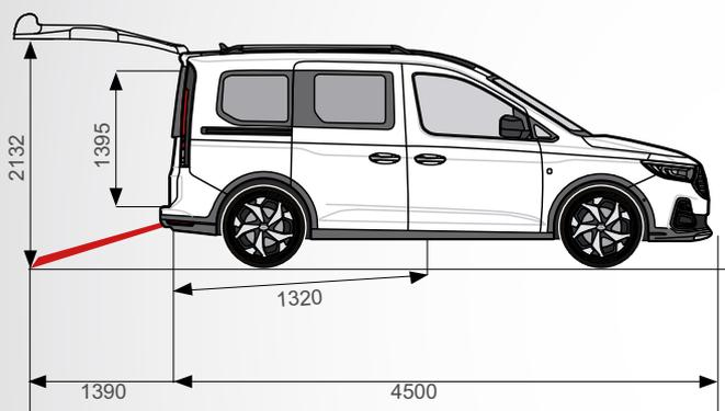
Altezza punto di ingresso 1395 mm | Altezza interna utile 1393 mm | Lunghezza tra gli ancoraggi 1265 mm | Lunghezza area stazionamento carrozzina 1320 mm | Larghezza area stazionamento carrozzina 815 mm | Lunghezza rampa aperta 1390 mm
