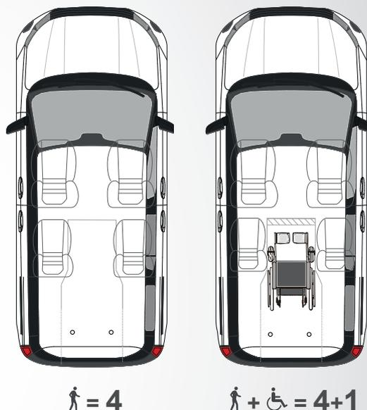
Altezza punto di ingresso 1365 mm | Altezza interna utile 1400 mm | Lunghezza utile tra gli ancoraggi 1025 mm | Lunghezza piano carrozzina 1420 mm | Ampiezza minima piano carrozzina 725 mm | Larghezza minima tra i sedili II° fila 520 mm | Larghezza massima tra i sedili 680 mm | Lunghezza rampa aperta 1360 mm | Ampiezza utile rampa 720 mm.
