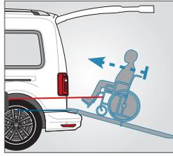
F-Winch è l'innovativo verricello elettrico che assiste l'accesso della carrozzina al veicolo, delicatamente, senza alcuno sforzo per colui che accompagna. Dotato di ergonomico comando a filo o radio comando wireless F-Remote.
