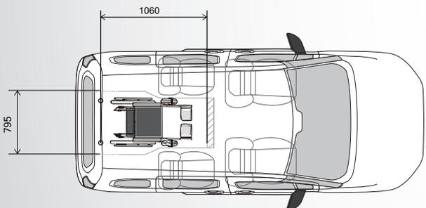
Altezza punto di ingresso 1409 mm | Altezza interna utile 1418 mm | Lunghezza tra gli ancoraggi 1060 mm | Lunghezza piano carrozzina 1315 | Ampiezza minima piano carrozzina 795 mm | Larghezza minima tra i sedili II° fila 590 mm | Larghezza massima tra i sedili 660 mm | Lunghezza rampa aperta 1315 mm | Ampiezza utile rampa 785 mm | Altezza del portellone aperto 2077 mm
