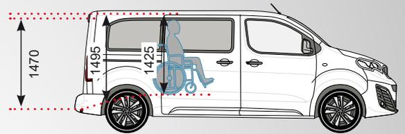
In alternativa è possibile configurare Peugeot Traveller versione Standard con due sedili singoli installati al posto della panchetta della seconda fila. In questo modo aumenta lo spazio a bordo e la persona in carrozzina può viaggiare tra i due passeggeri seduti in seconda fila.
