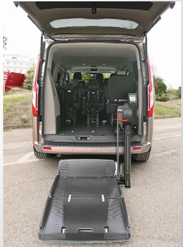
La base girevole **F-Twister** consente la rotazione del sollevatore, liberando l'accesso al veicolo in caso di necessità e facilita le operazioni di ancoraggio della carrozzina e messa in sicurezza del passeggero. È per questo che quello di Tourneo Custom con Sollevatore Fiorella è un allestimento **Easy=Safe**.
