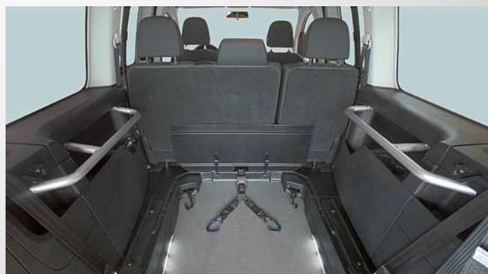
Verricello di carico F-Winch e mancorrenti in vernice metallizzata disponibili in optional
