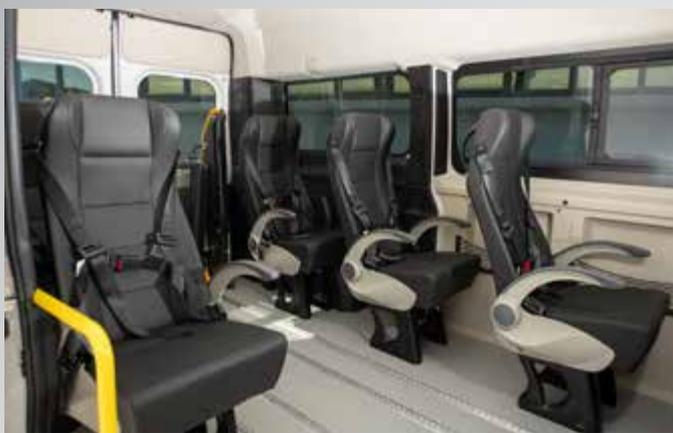
I nuovi sedili singoli sono dotati di poggiatesta ad origliera e cintura di sicurezza a 4 punti. Adatti ad accogliere sia persone normodotate che persone con lievi difficoltà di deambulazione.
