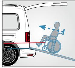
**F-Winch** è l'innovativo verricello elettrico che assiste l'accesso della carrozzina al veicolo, delicatamente e senza sforzo alcuno per l'accompagnatore. Dotato di ergonomico comando a filo o radio comando wireless F-Remote.
